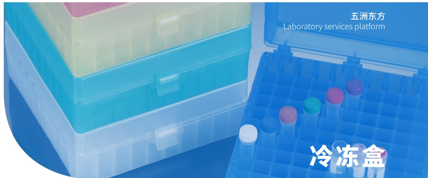
五洲东方提供高品质 PP、PC 和纸质三种材质的冷冻盒，用于冷冻样品的存储和保存，盖子和盒体有定位标识，防止在运输和存储中错位。纸质冷冻盒耐低温达 -100°C，PC 冷冻盒可在 -196°C 至 121°C 条件下正常使用，PP 冷冻盒可在 -80°C 至 121°C 条件下正常使用。
