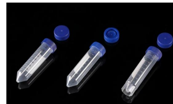
五洲东方离心管采用耐高温耐高压高质量聚丙烯 (PP) 制作而成, 管盖由高密度聚乙烯 (HDPE) 制作而成。
