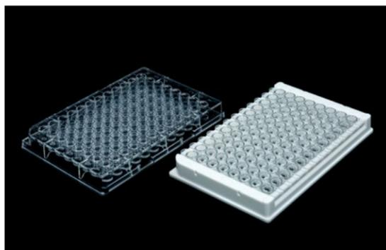
五洲东方酶标板是专为酶联免疫吸附试验设计, 符合 ANSI SBS 标准, 适用于用户建立在酶联免疫吸附试验和试剂盒生产时的各种可能的需要, 可根据抗原、抗体的性质和特点进行优化选择。
