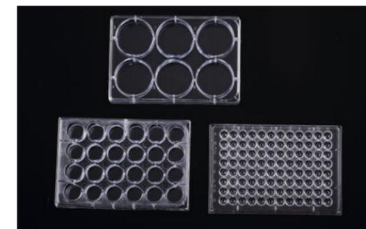
五洲东方细胞培养板选用高透明度的 100% 纯聚苯乙烯 (PS) 制作而成, 使用真空等离子技术做表面亲水性处理, 均匀处理的亲水性表面在细胞培养过程中使得细胞能够迅速贴壁生长。适用于细胞和培养中初期实验条件摸索和优化等实验过程, 应用于培养蛋白定量和 MTT 检测等, 流式一般使用 6 孔, MTT 一般使用 96 孔。
