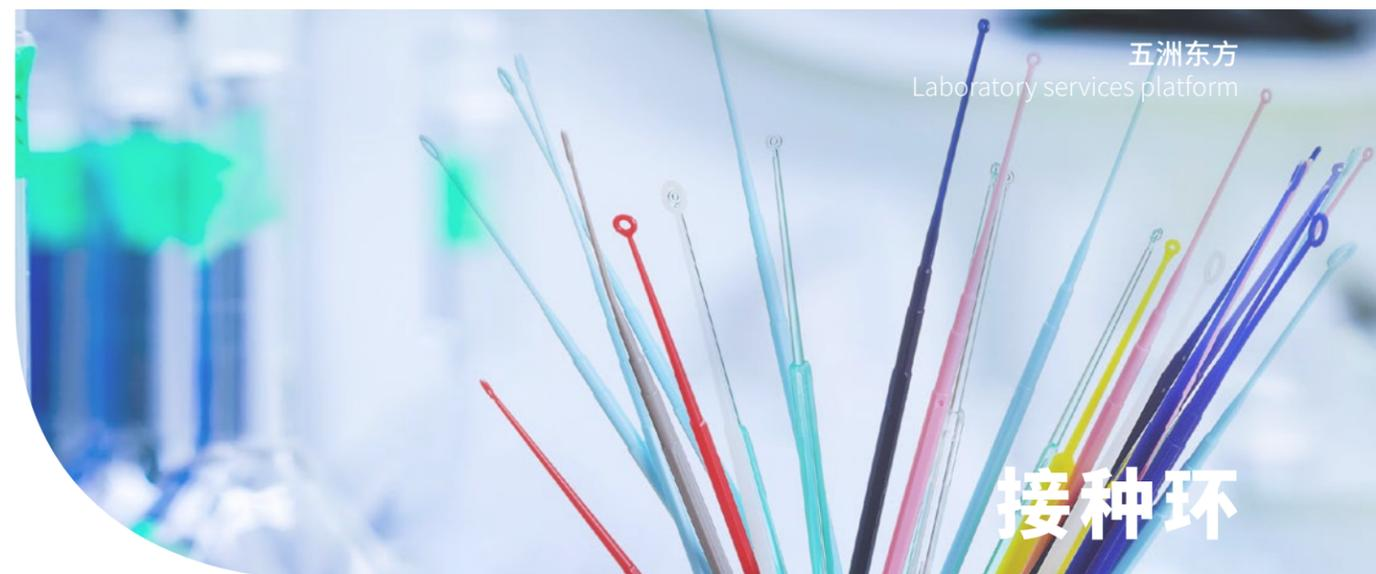
五洲东方接种环适用于理想的划线与接种，而不损害表面，一次性无菌设计消除了交叉污染的风险。
